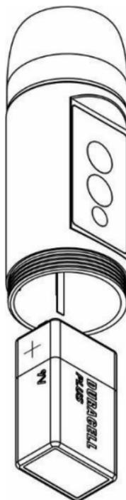
**NOTA:** Insertar la batería de forma incorrecta, no daña el dispositivo pero éste no funcionará.
